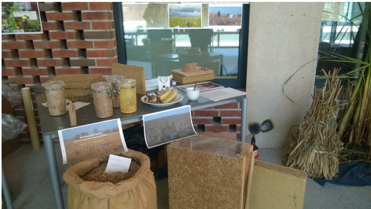
Isoleringsmateriale lavet af dunhammer i Tyskland. Foto: Frank Bondgaard, SEGES.
